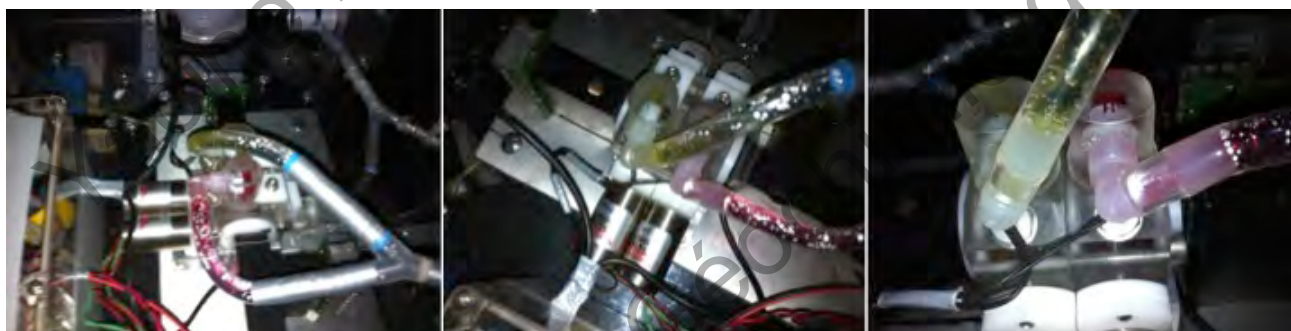
Figure 4.45 MAC-2 . Cellules à la fin du déploiement. Le rinçage n'étant plus effectué, les indicateurs se sont accumulés dans les cellules.
