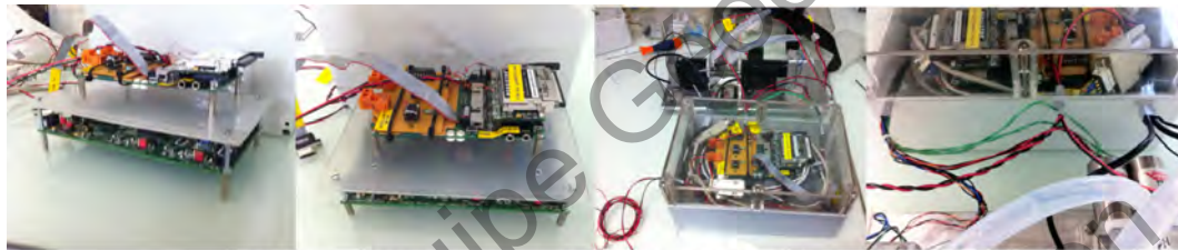
Carte Electronique et DL assemblés dans une boîte étanche
