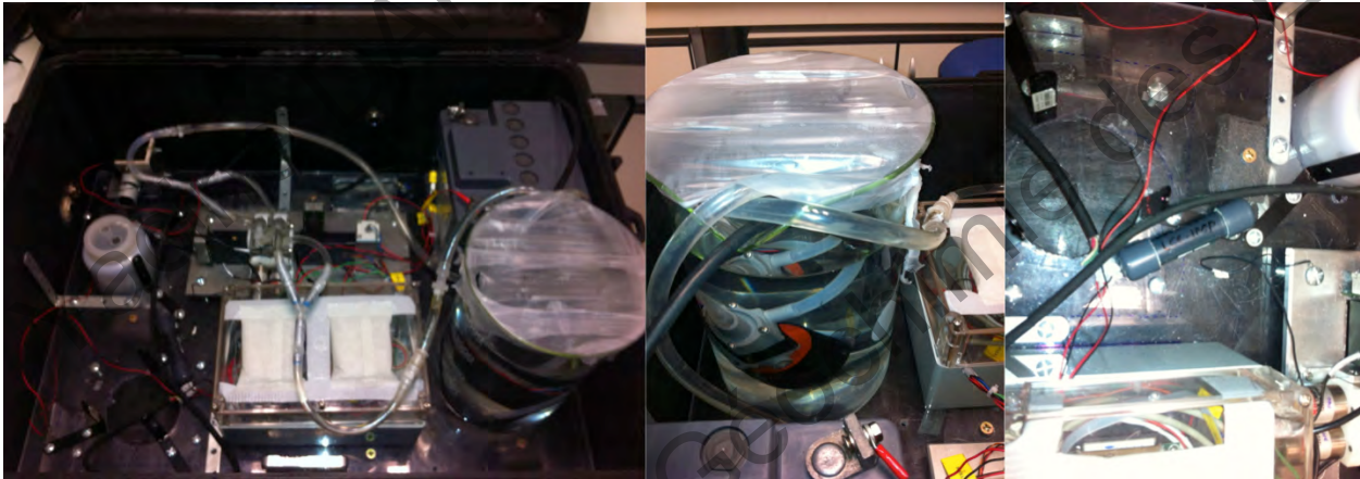
Figure 4.31 Tests température 100H – Le montage, la pompe à eau en circuit fermé et la sonde de température S2T (NKE).
