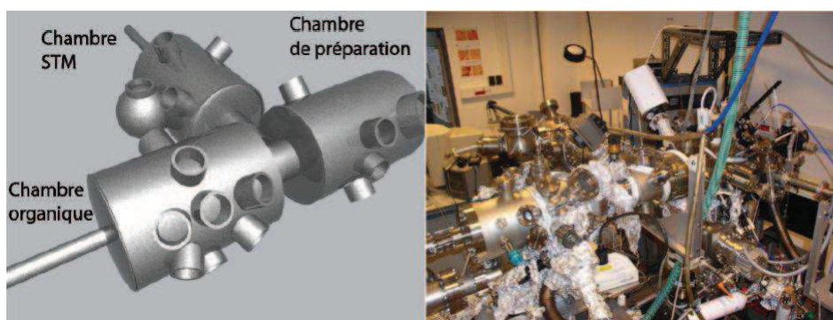
FIGURE 1.1 – Représentation schématique (à gauche) et photo (à droite) du système UHV au laboratoire.
