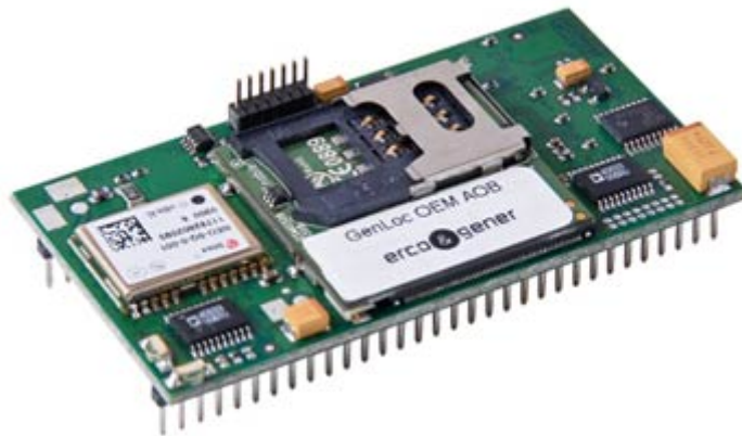
FIGURE 3.1 – Le module “GenLoc OEM AOB” utilisé
