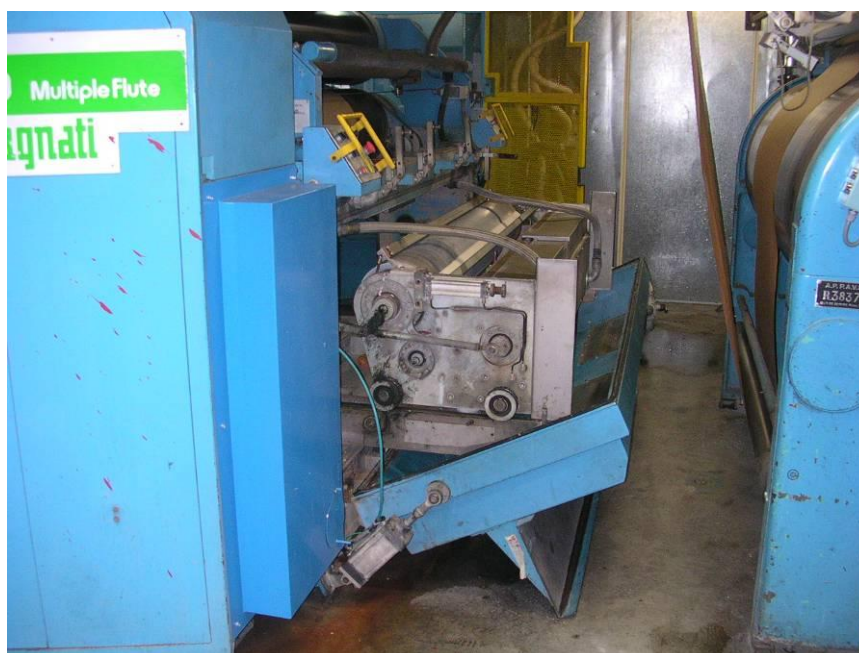
Figure 9. Capot de la colleuse ouvert
