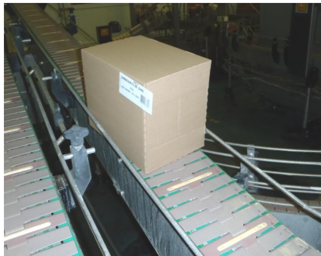
Figure 13 Défaut pack en travers
