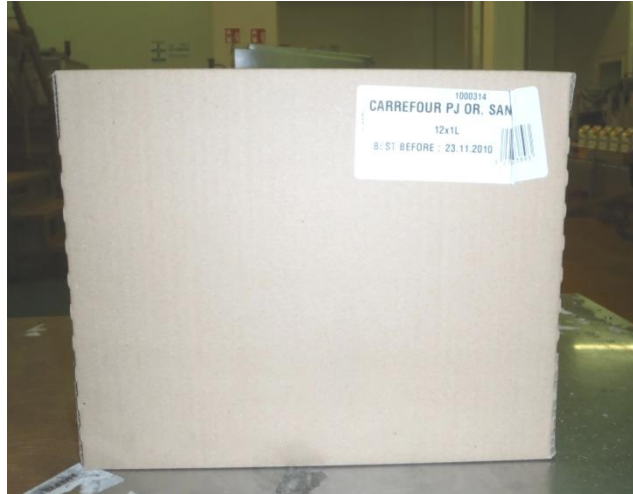
Figure 12 Défaut pose étiquette pliée
