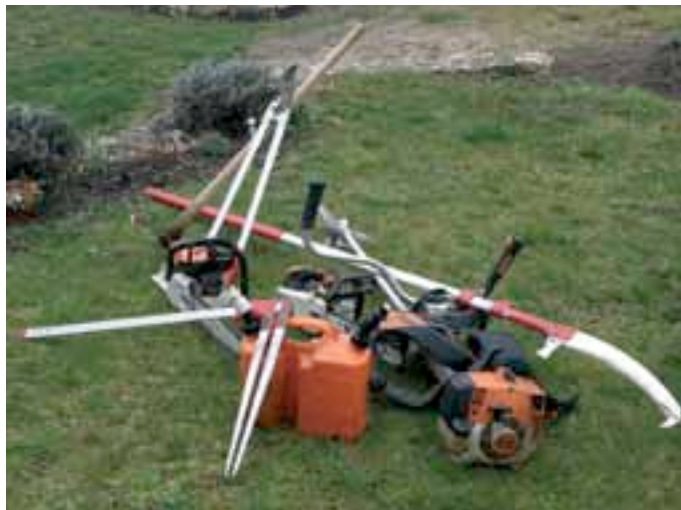
Matériel de Pierre : tronçonneuses, perche d'égale et sa scie, débroussailleuse, houe forestière, pied à coulisse, ébrancheur.
