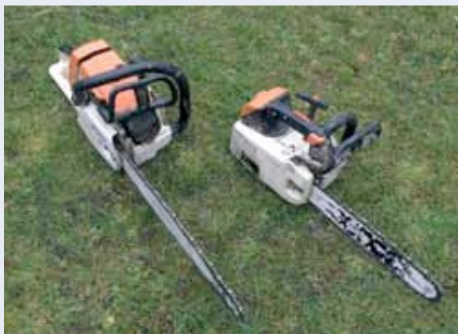
Les deux tronçonneuses les plus utilisées par Pierre, le plus souvent sur ses chantiers de dépressage, à savoir une Stihl MS 200 et une MS 260.
