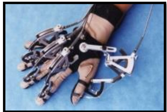
Figure 14 : Gant à retour de force câblé Cybergrasp®
