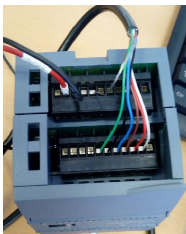
Fig17. Connexion de l'alimentation et du capteur de pesage au module de pesée Siwarex
