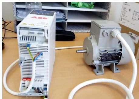
Fig4. Photo du montage VSD + moteur
