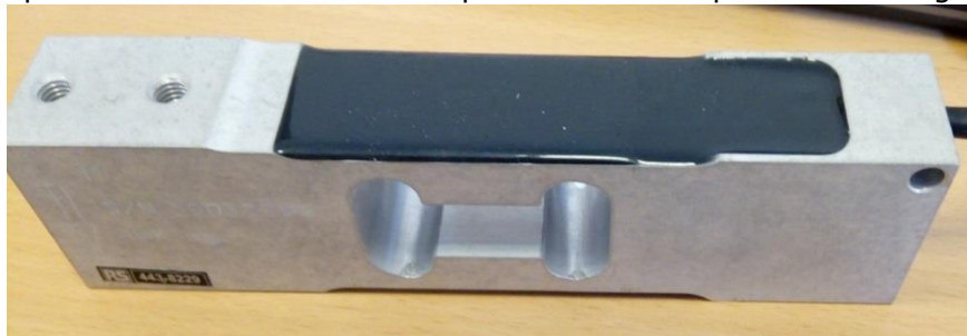
Fig14. Cellule de charge utilisée lors de la mission
