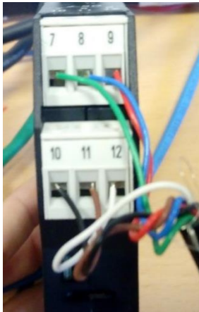
Fig15. Connexion du capteur de pesage au convertisseur Z-SG
