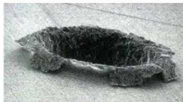
Figure 1.2: Impact d'un débris sur la paroi d'un satellite artificiel.
