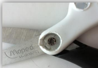
Figure 8 – Démontage du rivet
