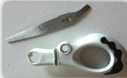
Figure 10 - Séparation des lames avec leur manche
