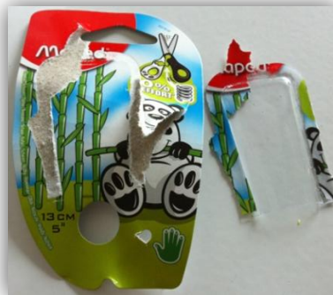
Figure 13 - Résidus du carton sur le plastique
