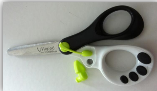
Figure 5 - Démontage de la partie servant de ressort d'ouverture des lames
