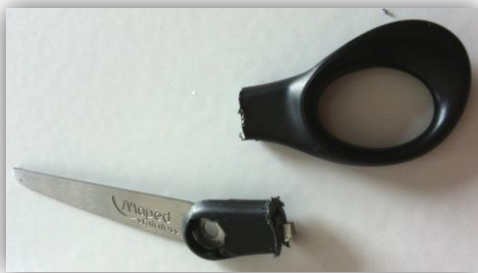
Figure 10 - Séparation des lames avec leur manche
