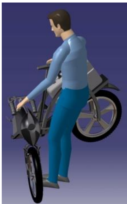
Figure 43 - Phase de pliage du vélo (2/4)
