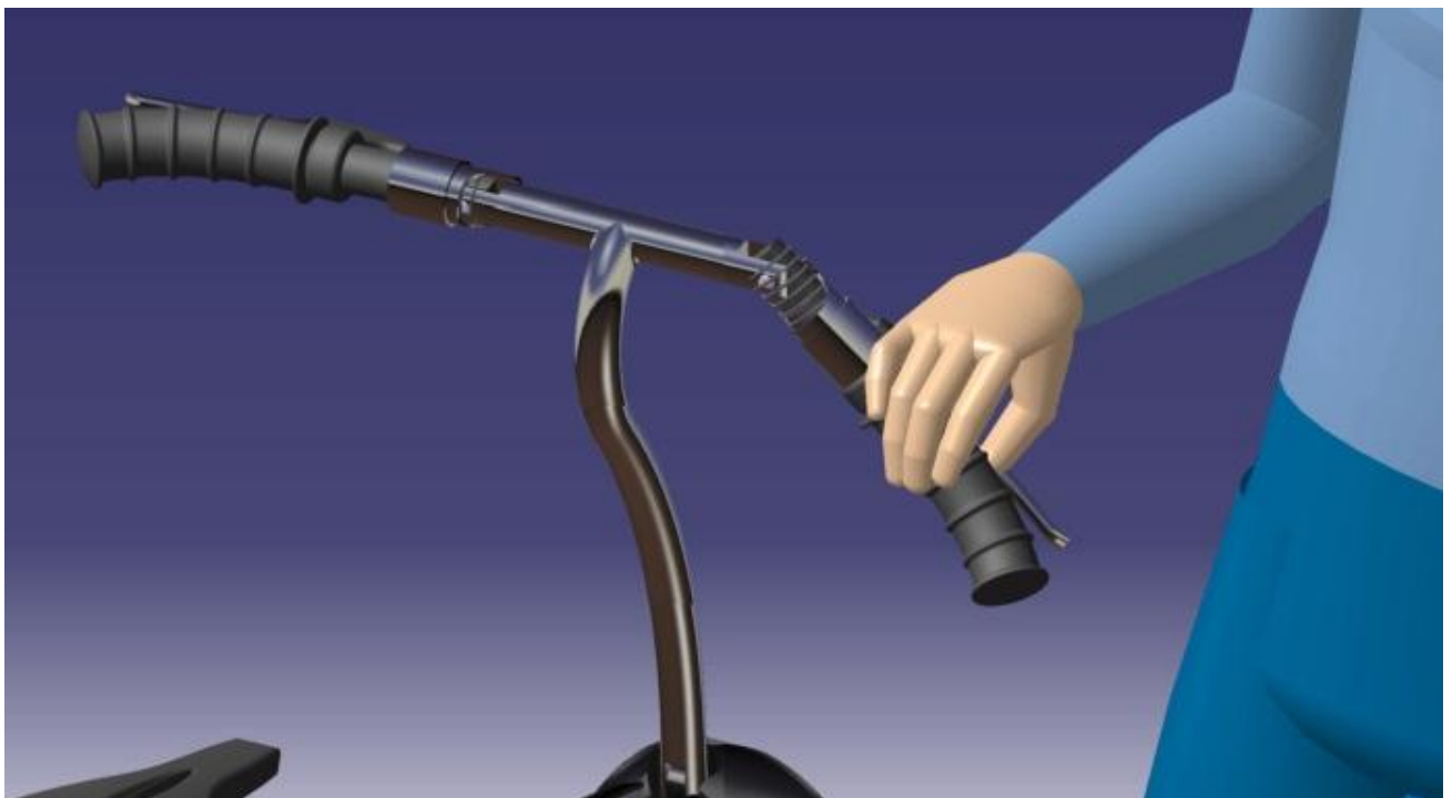
Figure 34 - Pliage des poignées
