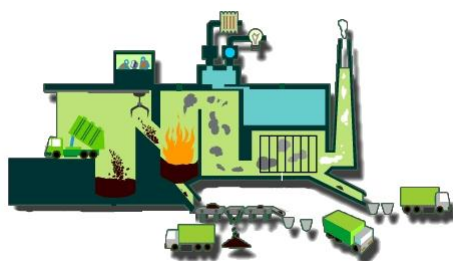
Schéma d'une centrale d'incinération ordinaire
