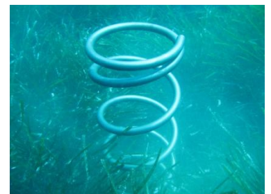
Figure 17 Ancre à vis pour le balisage (Photo P.Andréini)
