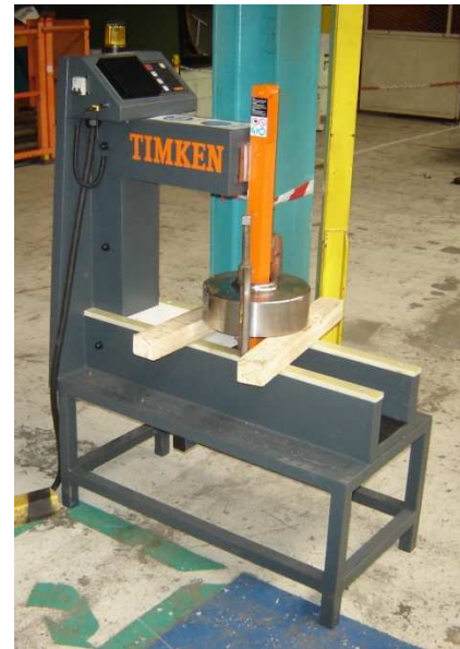
Photo 8 : le chauffe-roulement utilisé pour les essais
