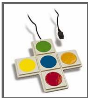
Quatre contacteurs pour bouger le curseur de la souris et le contacteur central pour sélectionner.
