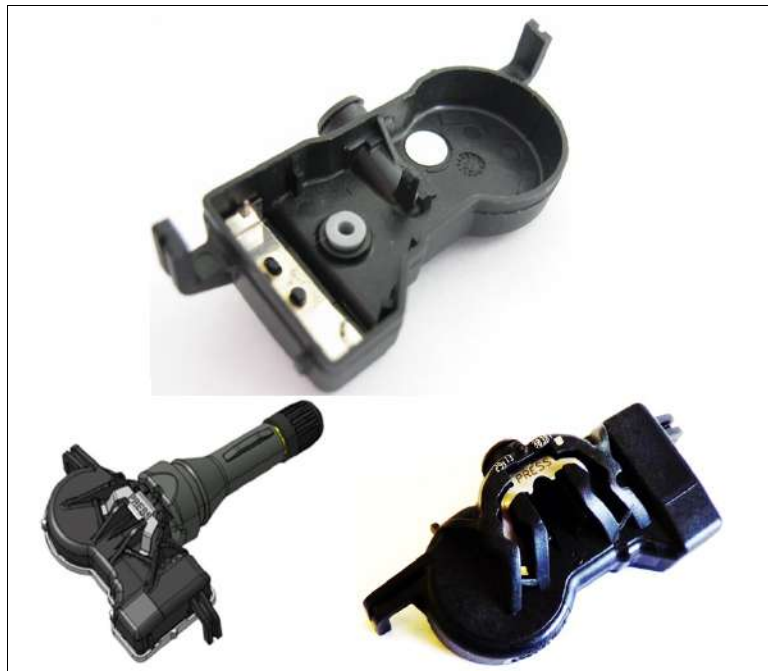
Fig. 8 : Photographies de la pièce finale et CAO du capteur de pression
