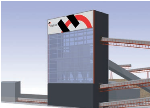
Les silos qui servent au dosage des matières premières sont entourés d'un bardage translucide. Cette tour participe à l'animation du site et pourra servir d'outil didactique dans le cadre de visites du site.
