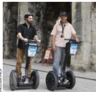
Le gyropode est un engin d'origine américaine qui a une autonomie de 40 kilomètres à faible vitesse et peut atteindre 20 km/h.
