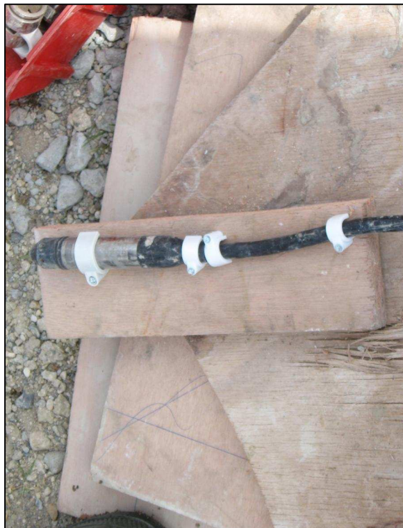
Photo n° 5 : Capteur piézométrique maintenu à une calle de bois.
