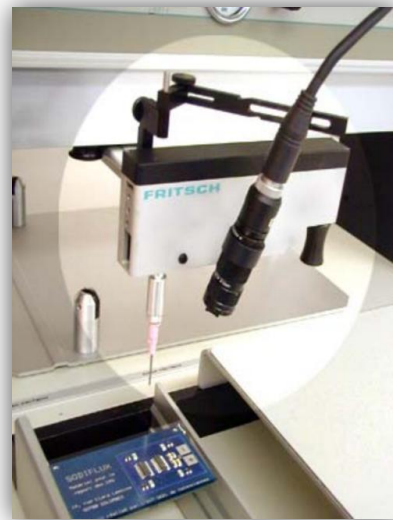
Outil de placement manuel de cms FRITSCH LM901
