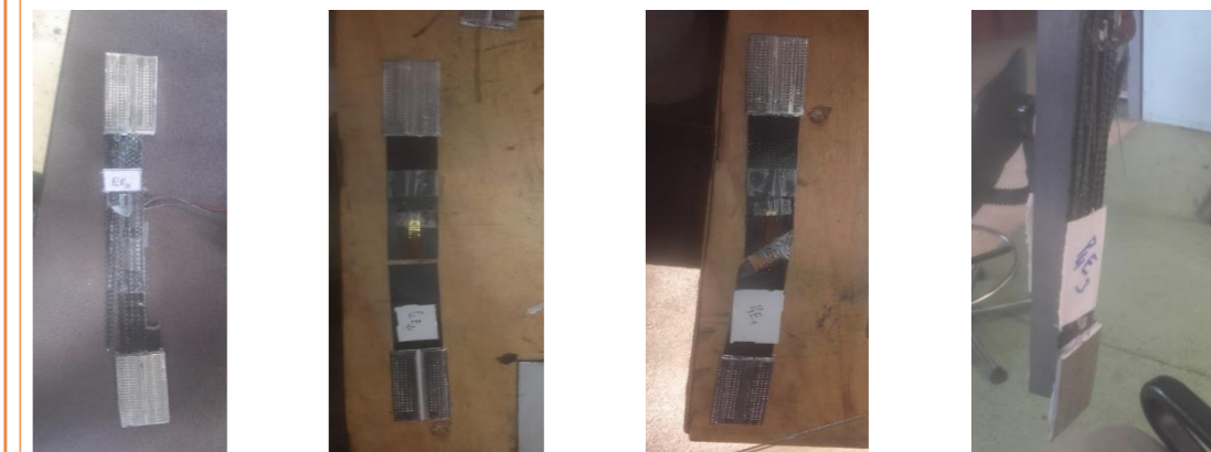
Ruptures de matrice et de fibres, Rupture de matrice, Ruptures de matrice et de fibres + Décohésion/Décollement, Ruptures de matrice et de fibres + Décollement
