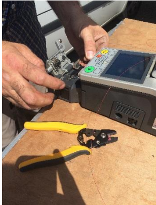
Figure 26 : Cliveuse utilisée sur le terrain
