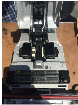
Figure 27 : Soudeuse avec arcs électriques
