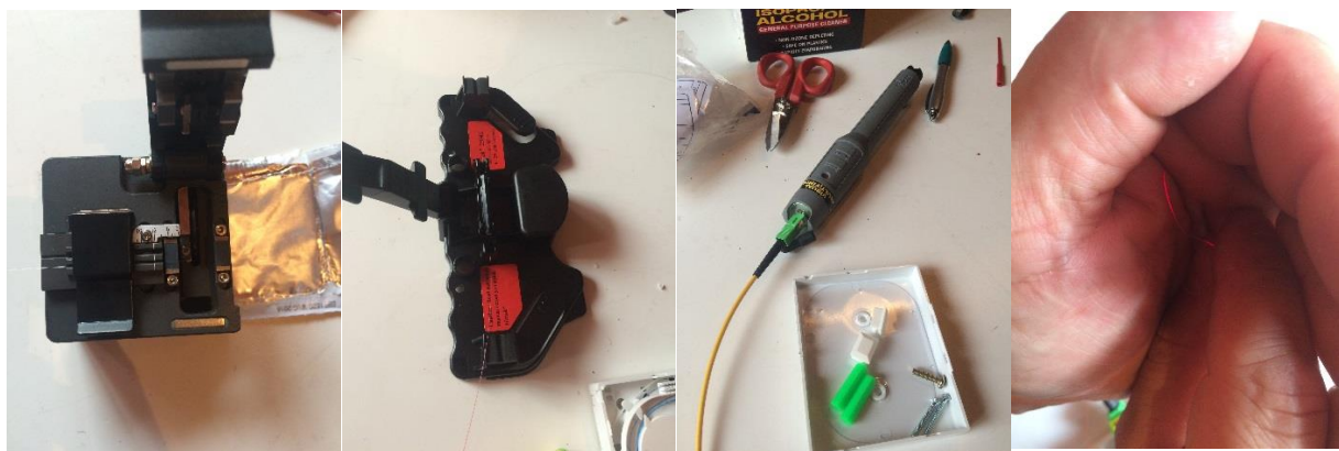
Figure 35 : Cliveuse ; Machine utilisée pour reliure ; Stylo laser ; Visualisation de la lumière passante après la soudure
