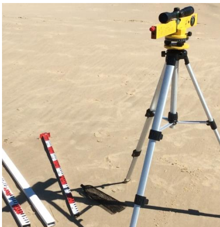
Figure 5 Trépied et échelle utilisés pour la modélisation des profils
