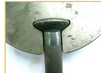
Vérification gabarit CEI
